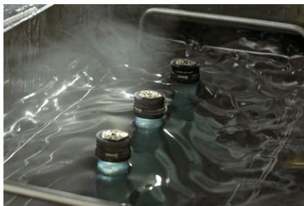
▲液体急速冷凍機「凍眠」で日本酒を超高速冷凍中
